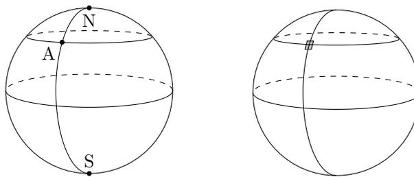
このかけらが円柱面にどういう風に写像されるのかというのを考える. 北極があって, 南極があって, これらを通るような大円があります. 大円とは何なのかというと, 原点を通るような平面で切った球の切り口. いまの大円は, 北極と  $A$  を通るようにしたいから, 北極と中心と  $A$  を通るような 3 点を取って, その平面での切り口を見る. もう 1 つ,  $A$  を含むような水平な平面で切る. 高さ  $z$  だけは固定して,  $x, y$  は全部勝手に動いてよいという平面.
